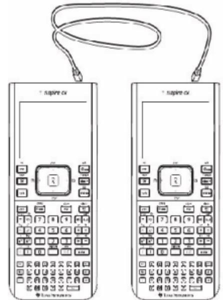
1. Schließen Sie zwei Rechner mit Hilfe des USB-Kabels mit 2 Mini-USB-Steckern zusammen und schalten beide Rechner an.
